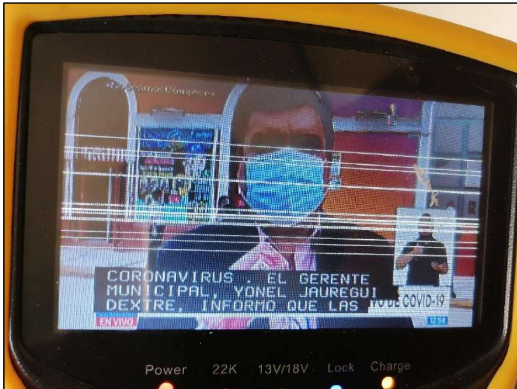
Imagen 17. Señal recibida por antena parabólica y LNB, lo que muestra que está correctamente enlazada con satélite Intel-Sat.
