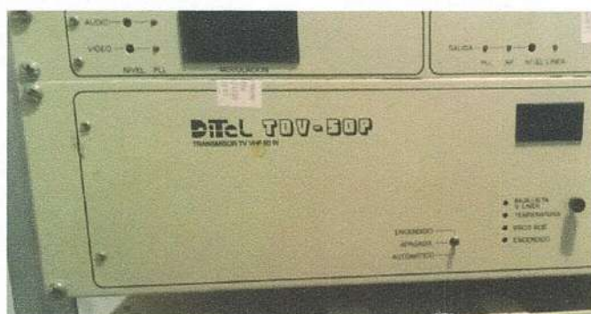
Ilustración 2. Se puede verificar que el trasmisor DITEL TDV – 50P Y EL MODULAROR DITEL MB600
